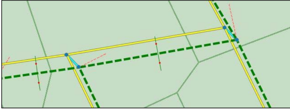
Abbildung 12: Beispiel für ein 1D-1D Modell, in dem die Straßenflächen als offene eindimensionale hydrodynamische Gerinne abgebildet werden (CHlwater 2012b); In Gelb ist das Kanalnetz abgebildet und in Grün das Straßennetz mit seinen Querschnitten. In Hellblau ist die Koppelung an den Schächten dargestellt.
