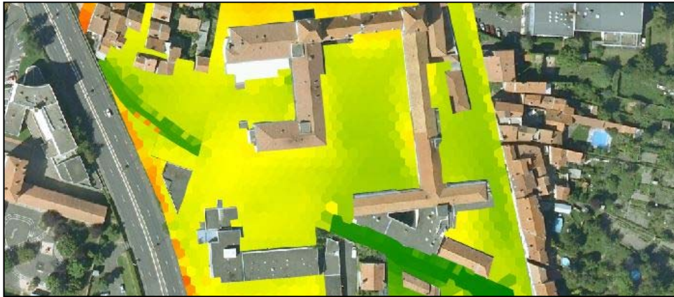
Abbildung 13: Beispiel für ein 1D-2D Modell mit einem Orthofoto als Hintergrundbild, um die Strukturen zu zeigen, um welche das Oberflächengitternetz auf Grundlage eines DGM generiert wurde; Das Oberflächengitternetz ist nach den maximalen Zellohöhen – Grün sind tiefe Lagen bis Rot sind hohe Lagen – gerendert (CHwater 2012a).
