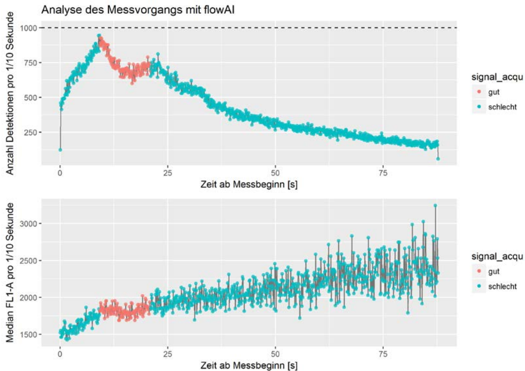
Abbildung 39: Darstellung des zeitlichen Messverlaufs (Anzahl der Detektionen und Median von FL1-A für Zeitabschnitte von einer Zehntelsekunde) jener Messung mit dem höchsten ausgewiesenen Anteil an auffälligen Detektionen nach dem Kriterium „signal acquisition“. Die gestrichelte Linie im oberen Teil der Abbildung stellt die vom Hersteller angegebene maximale Detektionsrate dar
