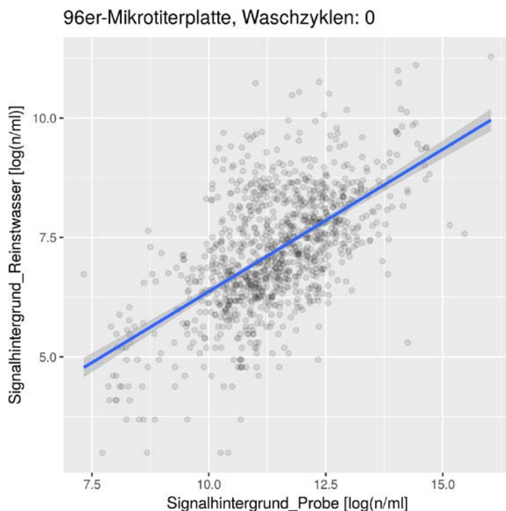
Abbildung 53: Gegenüberstellung des Signalhintergrunds gefärbter Wasserproben ( n=1059 ) zu jenem in anschließenden Messungen von Reinstwasser zu Reinigungszwecken (Accuri® C6, automatischer Messmodus) mit Regressionsgeraden (lineare Regression, blaue Linie) und Konfidenzintervallen (grau hinterlegt).
