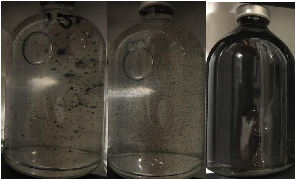
Abbildung 26: Batchflaschen mit Inokulum der Kulturen von bioclear (links), KB-1 (Mitte) und einem institutseigenen Konsortium (rechts)
