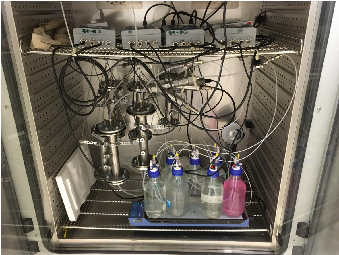
Abbildung 33: Durchführung Säulenversuch PCE
