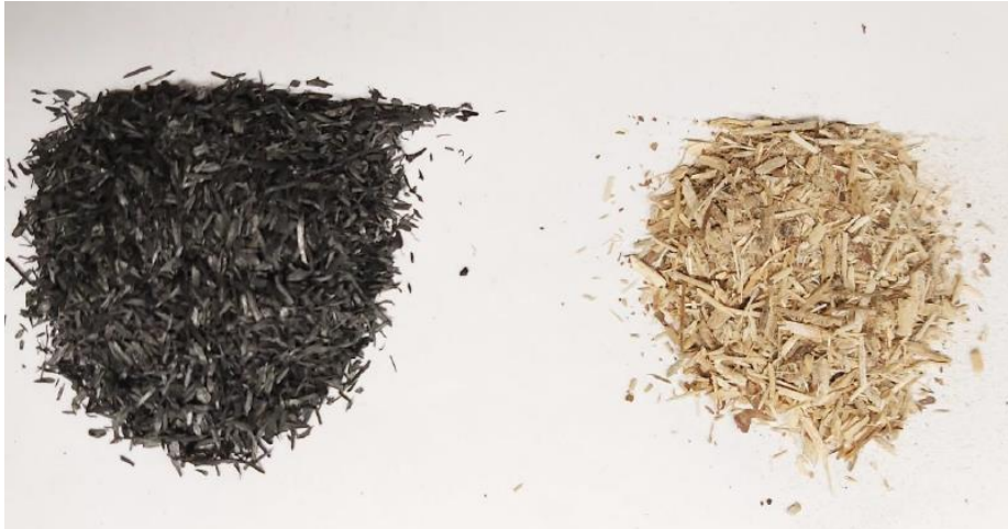
Abbildung 11: Für die Pyrolyse vorbereitete Holz-Hackschnitzel (rechts) und das nach Pyrolyse bei 550 °C erhaltene Karbonisierungsprodukt (links).
