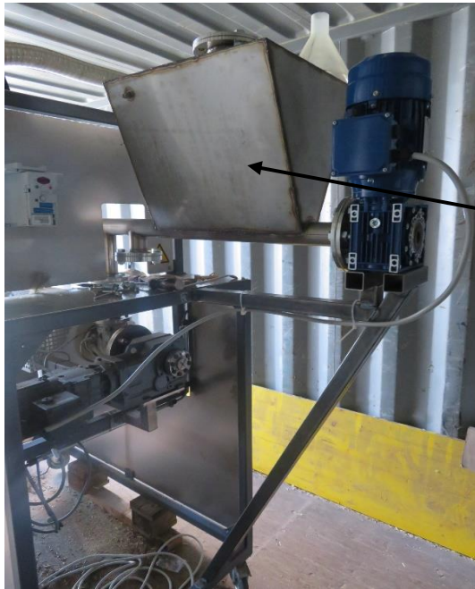
Abbildung 9: Umgebauter und gasdicht gemachter Probeneintrag (Komponente 1 aus Abbildung 7).
