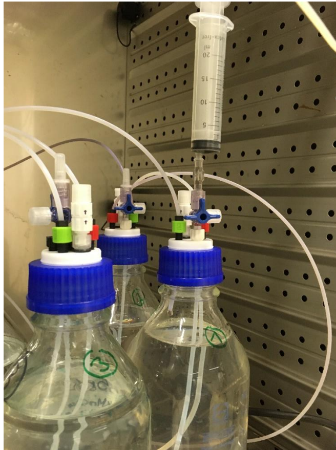
Abbildung 34: Aufbau Reservoirverschluss (Vici Safety-Cap) mit zwei Verbindungsschläuchen zum Säuleneingang und -ausgang, Überdruckventil, 3-Wege-Ventil für die Zugabe von z.B. Reduktionsmittel, Pufferlösung.
